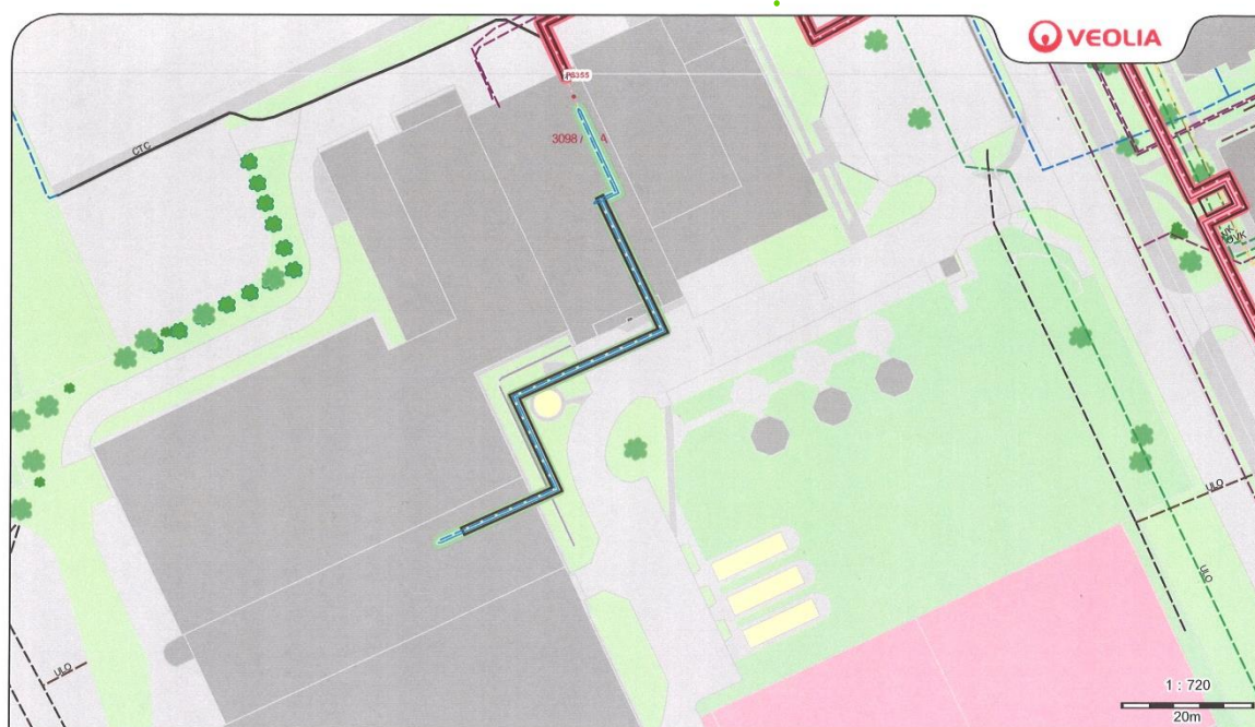
Obr. č. 3 – Vedení parní přípojky a podzemního kolektoru
